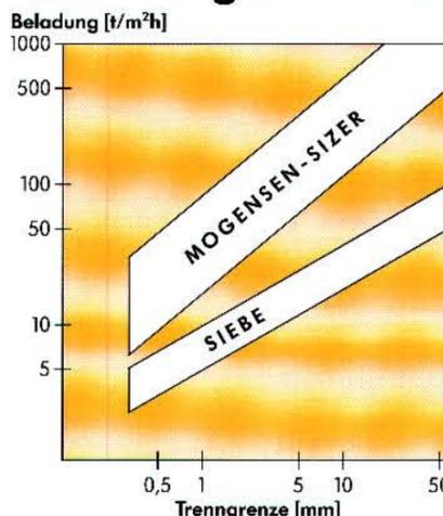
Die perfekte Abstimmung von progressiver Neigung, überdimensionierten Maschenweiten und idealer Motor-Amplitude ermöglicht weitaus höhere spezifische Durchsatzleistungen als bei konventionellen Siebssystemen. Denn das Feingut fließt ungehindert und extrem schnell durch die großmaschigen Gewebe, während die groben Partikel sehr früh von den oberen Decks ausgetragen werden. Eine Materialbettbildung ist dadurch ausgeschlossen.
